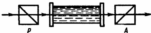
Рис.34.9. Схема сахариметра.
